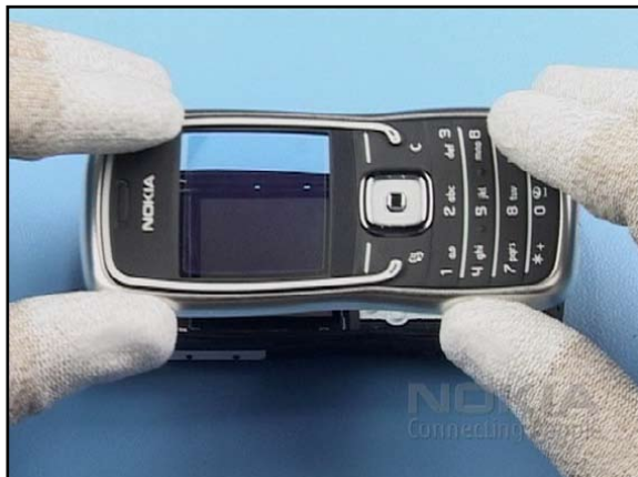
12. ...and remove the A-COVER METAL FRAME.
