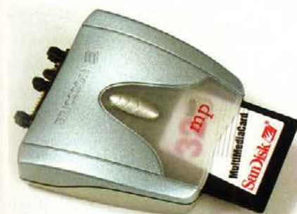
Az Ericsson HPM-10 modulba csak egyszerűen be kell csúsztatni a multimédia kártyát.
