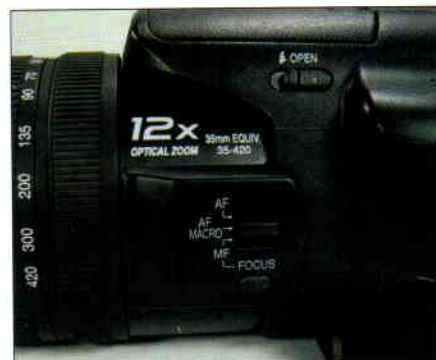
Ide is sikerült egy kis változtatást rakni. A korábbi modelleken még nem volt autofókusz makróüzem módban.
