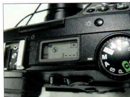
Feltehetőleg az analóg szériából öröklődött ez a másodlagos kijelző, amelyen a legfontosabb paramétereket mindig megtaláljuk.
