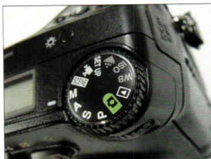
Számomra roppant tetszetős, hogy a programtárcsán találjuk a felbontás-, fehér-egyensúly- és ISO-beállítást.
