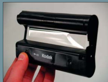
Jól látható középen a fényvisszaverődés, a hártya maga a termofólia. Kifogyás esetén az egész szerkezetet egy könnyed kézmozdulattal kihúzza tudjuk cserélni.
