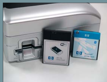
A nyomtatóban nincs vezeték nélküli átviteli modul. A gyártó viszont kínál memokártya-kialakítású külső modult.
