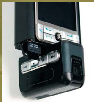
A készülék memóriája microSD-kártyával bővíthető, már amennyiben sikerül megtalálni a kártyát fogadó részt. A kártyafoglalat ugyanis az alsó rész elforgatása után érhető el.
