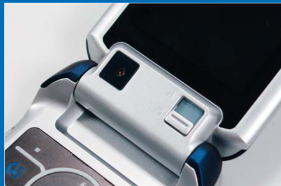
A V3x mechanikus makrokapcsolóval dolgozik, a kis lencse szemmel láthatóan is mozog. Az eredményre mindez jó hatással van, de még mindig ne ezzel fotózzuk a hangyák nemi életét. Mellette a 3G-s kamera.
