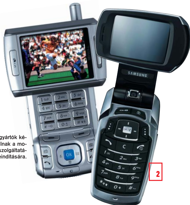
Itt az első OLED-techno- lógiájú kijelzővel felvértezett mobiltelefon.
