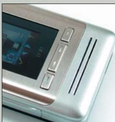
Csukott állapotban a zenelejátszó a készülék előlapján elhelyezett dedikált gombokkal vezérelhető.
