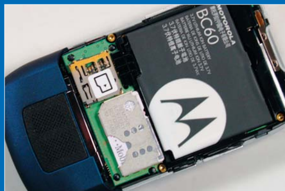
A kártya cseréjéhez az akkufedelet le kell venni, de legalább nem kell magát az akkut kivenni. Kissé talán bosszantó lehet, de a legelveteműbbek is jó esetben annyit cserélik, mint óvodás a pelenkáját.
