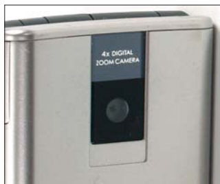
A beépített kamera csupán VGA (640x480) felbontású, ami manapság csak az elvárható minimumnak felel meg.
