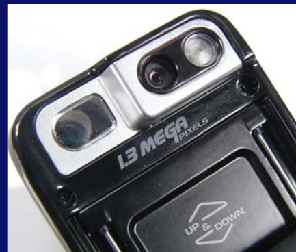
Az M6100 feltolható előlapjának hátoldalán helyezték el az 1,3 megapixeles képezőkével ellátott digitális kamerát.
