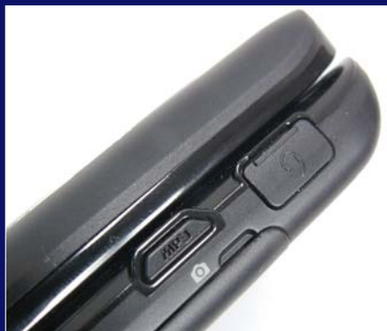
A telefon oldalán található az MP3-lejátszó indítógombja (nyitott állapotban exponáló gomb) és a fülhallgató csatlakozója.
