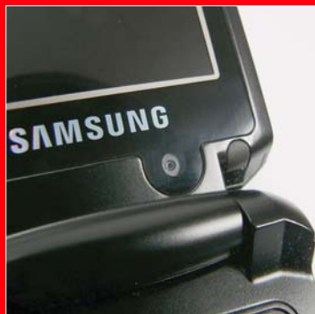
A belső kamera leginkább videotelefonálások bonyolítására alkalmas, erre elég is a VGA-felbontás. Ezzel képkészítésre jobb, ha nem adjuk a fejünket.
