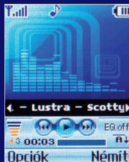
A zenelejátszó funkcióhoz 128 MB belső memóriát biztosít a készülék, a tárhelykapacitás azonban nem bővíthető.
