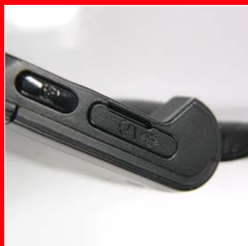
A készülék oldalán lévő csatlakozó előnye, hogy a töltő, a headset, illetve az USB-kábel is ide csatlakoztatható, ráadásul egy műanyag sapka védi a portól és a piszoktól.
